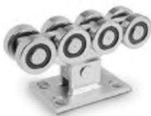
Профессиональная, 8-роликовая опора с цельной плитой и усиленными герметичными подшипниками со специальной низкотемпературной смазкой (до -60°C). Опоры в конструкции откатных ворот воспринимают нагрузки от створки ворот и передают их на фундамент. Совместно с направляющей обеспечивают перемещение створки.
