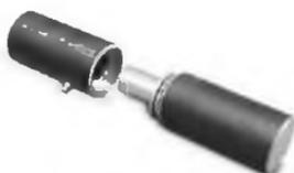
Петли со встроенным подшипником применяются для распашных ворот и калиток. Крепление производится при помощи сварки к столбу и створке ворот (калитке). Петли оснащены масленкой, которая предоставляет возможность смазки внутренних частей петли без ее разборки.
